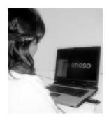
Un dispositivo con all'interno un <u>giroscopio</u>, posizionato sul capo dell'utilizzatore è in grado di rilevarne le variazioni di inclinazione; un software sul PC elabora questa informazione e trasforma i movimenti della testa nello spostamento del mouse sullo schermo.
